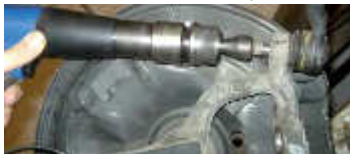
Spurstangenkopf austreiben (mit Nr. 8760)
