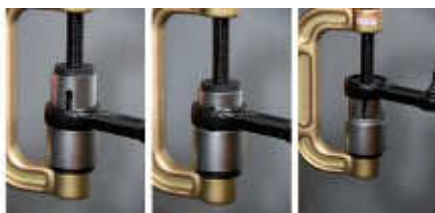
Auspressen einer Buchse am Beispiel eines Lenkers
