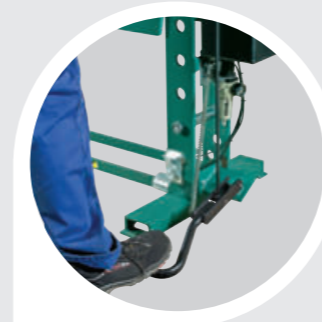
Freie Hände durch die Fußbedienung beim Modell FP 50.
